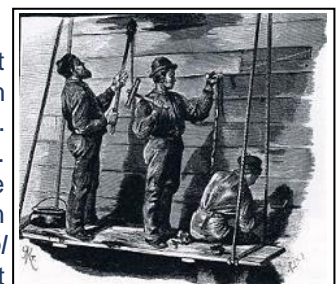
Kalfatern und Pichen eines Holzschiffes, von links mit Dweil, Kalfateisenhammer, Schaber
