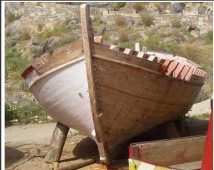
Kraweel-beplanktes kretisches Fischerboot bei der Restaurierung
